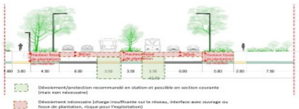
Figure 38 - Principe de dévoiement des réseaux
