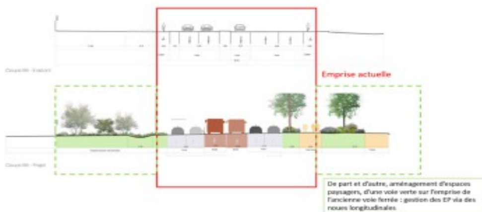
Figure 49 : Profil en travers sur l'entrée de Sète
