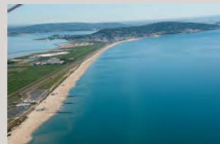
Aujourd'hui, la route littorale a été reculée près de la voie ferrée, la plage élargie et renforcée, des ganivelles retenant le sable installées, des parkings aménagés...
